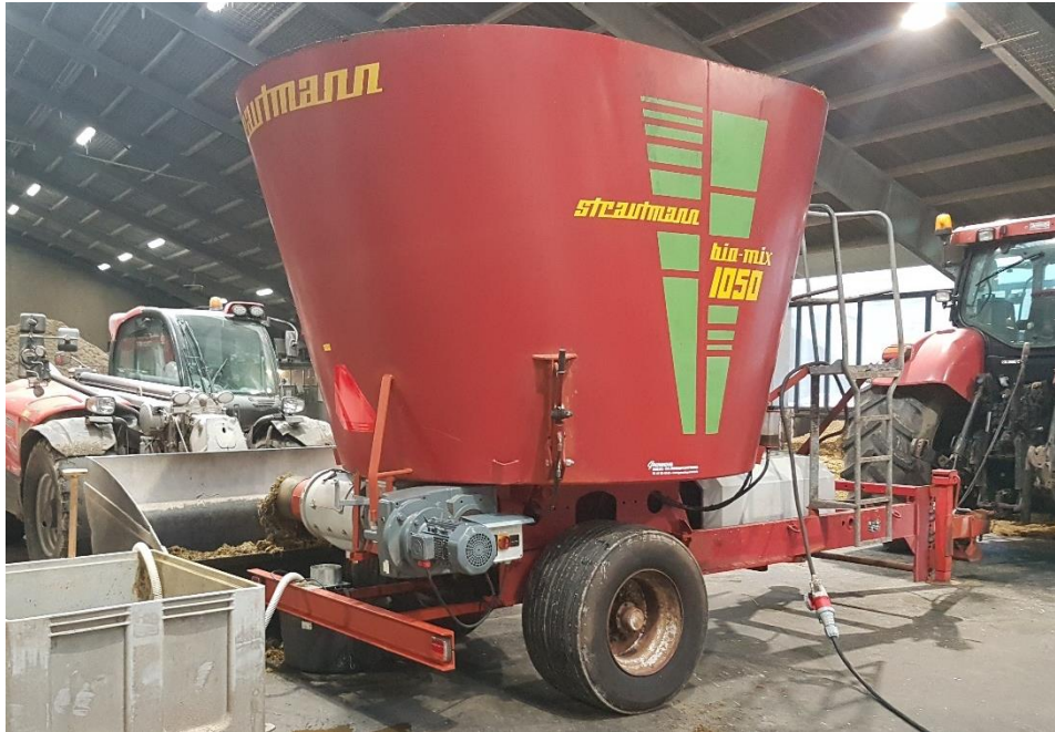
Foto 1. Skruepresse sammenbygget med el-drevet foderblandinger til fremstilling af lav-CAB græs fibre til forsurede Close-UP goldrationer og lign. Foto: Niels Bastian Kristensen
