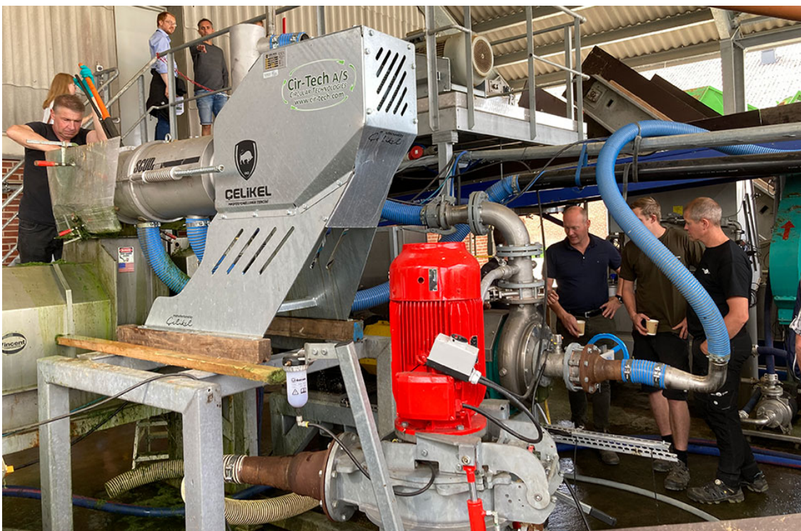
Det væskebaserede system: Rød i forgrunden: Distruptor fra Vogelsang, bag den Deflaker fra Cellwood
