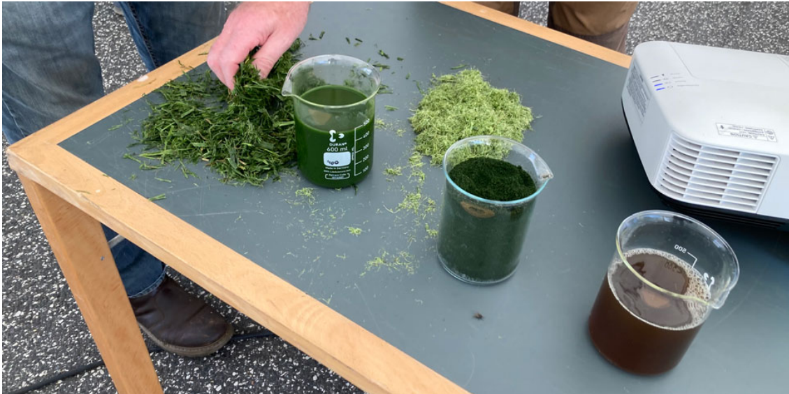
De fem materialer. Fra venstre: Snittet græs, grønsaft, græs fibre, proteinkoncentrat og brunsaft.
