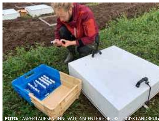
FOTO: CASPER LAURSEN, INNOVATIONSCENTER FOR ØKOLOGISK LANDBRUG Prøveudtagning i nedmuldningsforsøg. Lattergasemission måles med manuelle fluxkamre.
