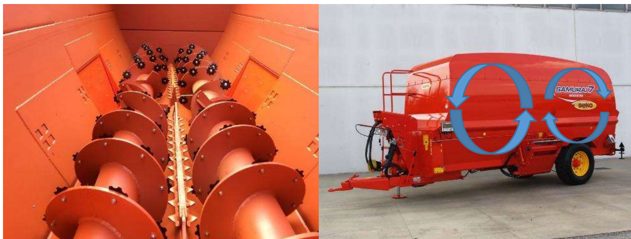
Figur 2 Billede TV af Seko-mikserens to sneglene med påmonterede sorte knive. Billede TH af Seko-mikseren med illustration af biomassens bevægelse rundt i vognen når sneglende roterer og flytter biomasse mod lugen på midten af vognen.
