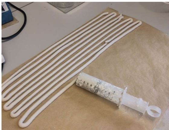
Figur 3: Illustration af sprøjtning af "Struvit - pillemasse"
