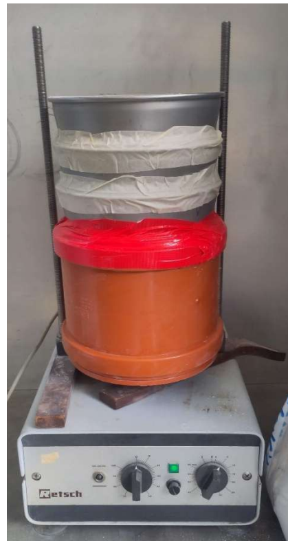
Figur 1: Opstilling af struvit filtreringstårn.
