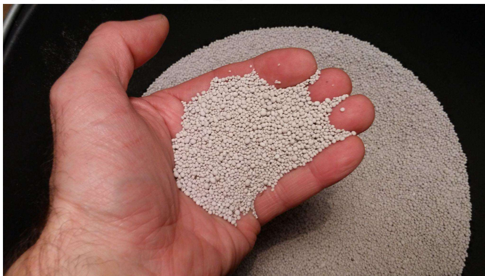
Figur 1. Struvit udfældet på Åby renseanlæg
