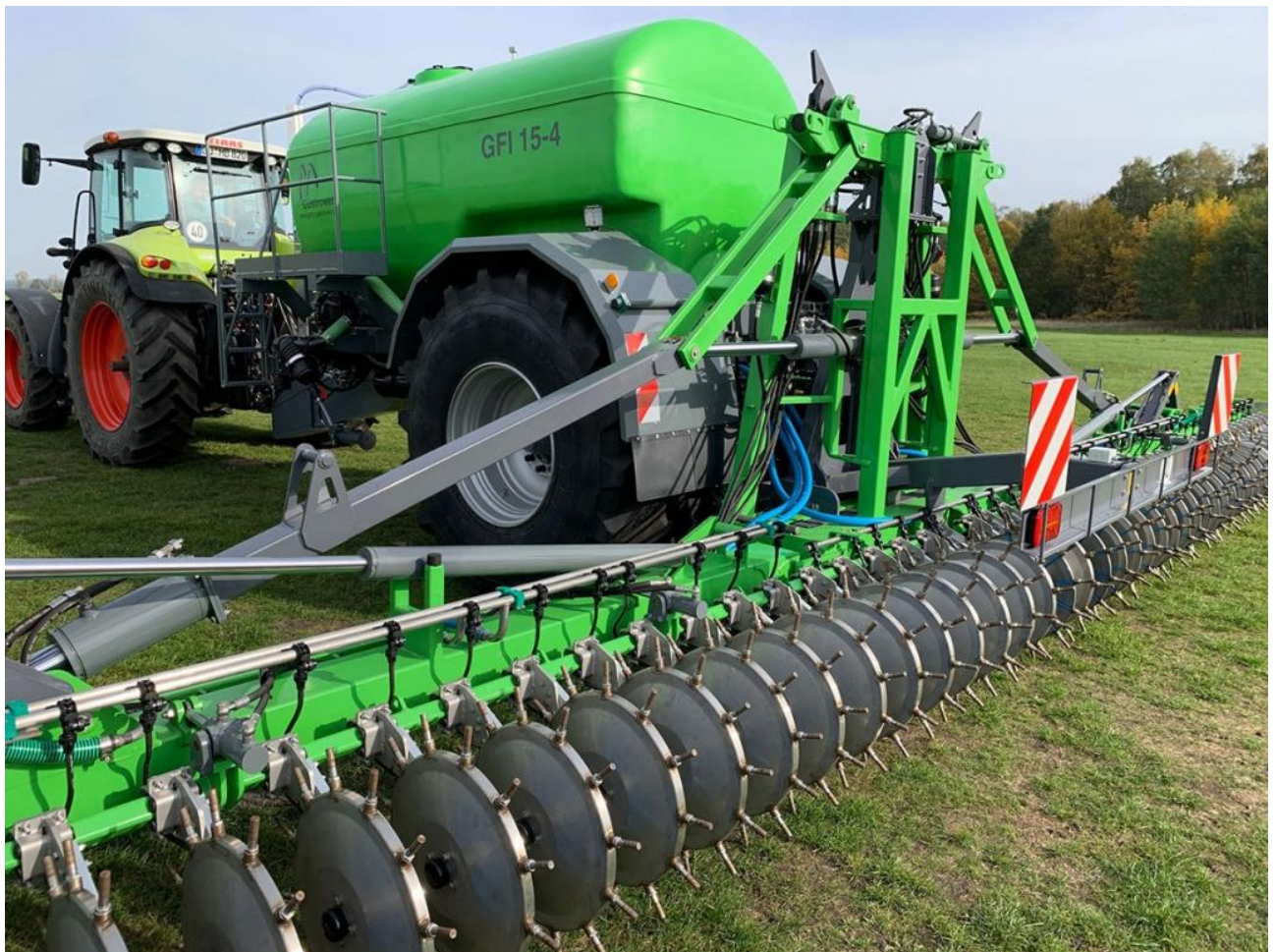
Figur 4 Eksempel på Cultan-spreder med stor arbejdsbredde. (Kilde: Güstrower Maschinebau [16])
