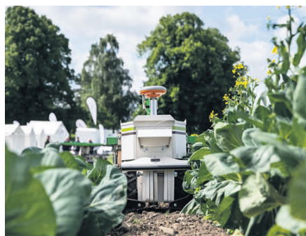
Naio Technologies udviklede oprindeligt en robot, der kunne rense rækkerne mellem vinranker. I dag har franskmændene udviklet flere modeller, hvis fællestræk er, at de kan radrense. Foto: Henrik Reintoft
