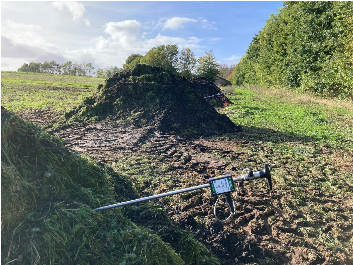
Foto 1: Eksempel på kompost som kan anvendes i plantebaseret sædskifte. Nyoplagte kompostmiler blandet af enggræs og have/park affald. Spyddet i kompostmilen måler og logger temperaturen i midten af milen, som kan tilgås via bluetooth.
