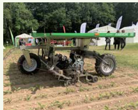
Farmdroid er en specialrobot til såning og rensning af rækkeafgrøder.
