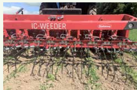
Steekeete IC weeder. Kamerastyring kan genkende roerne, hvilket giver effektiv rensning i og uden for rækken.
