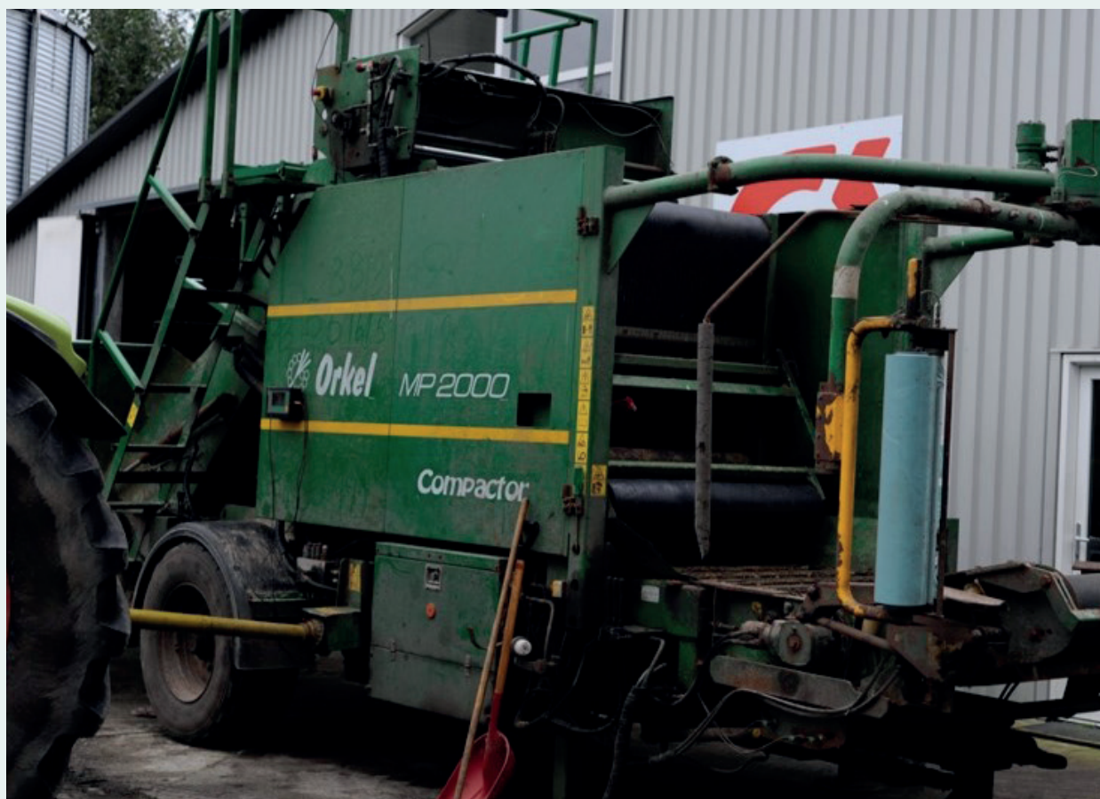
Orkel Compactor omdanner finsnittet grovfoder til kompakt pressede wrapballe, som er lette at opbevare og håndtere. Foto: Maja Eline Petersen, Økologi & Erhverv.
