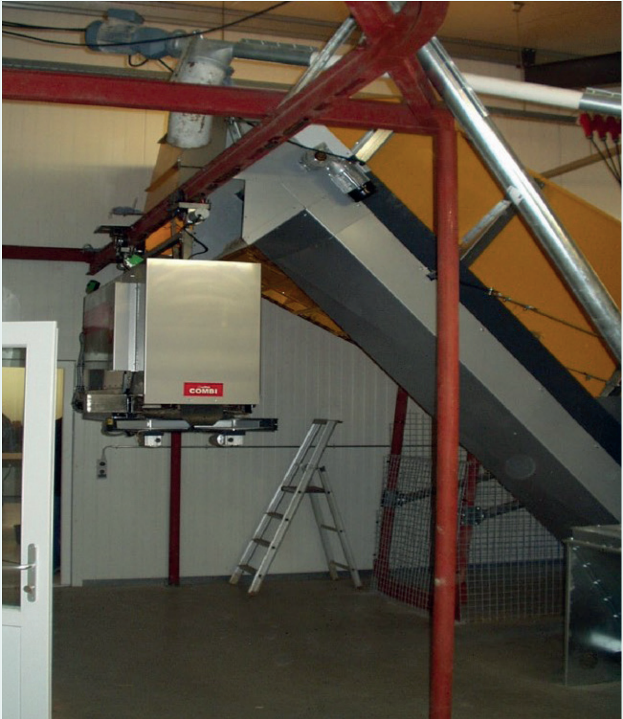
Et påslag på udfodringsanlægget doserer grovfoder i sprederbotten. Foto: Niels Finn Johansen, SEGES
