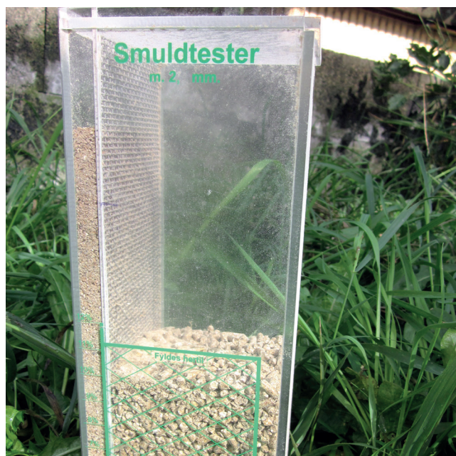
Billede 2: Brug smuldtesteren til at vurdere smuld ved levering og i foderautomaterne i de enkelte stier.
