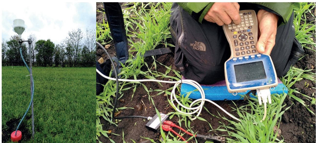
Tragt til opsamling af regnvand (til venstre). Måling af jordfugtighed til 90 cm dybde ved hjælp af metalstænger (TDR-prober) nedbanket i jorden (til højre).
