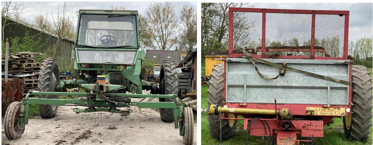
Figur 10: Brugt redskabsbærer og møgspreader tilpasset til 3,2 m kørespor (Foto: Erik Fog)
