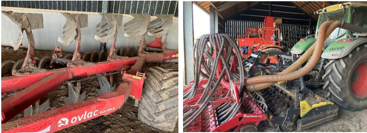
Figur 12: Skrælplov og specialsåmaskine til korn og hestebønner. (Foto: Erik Fog)
