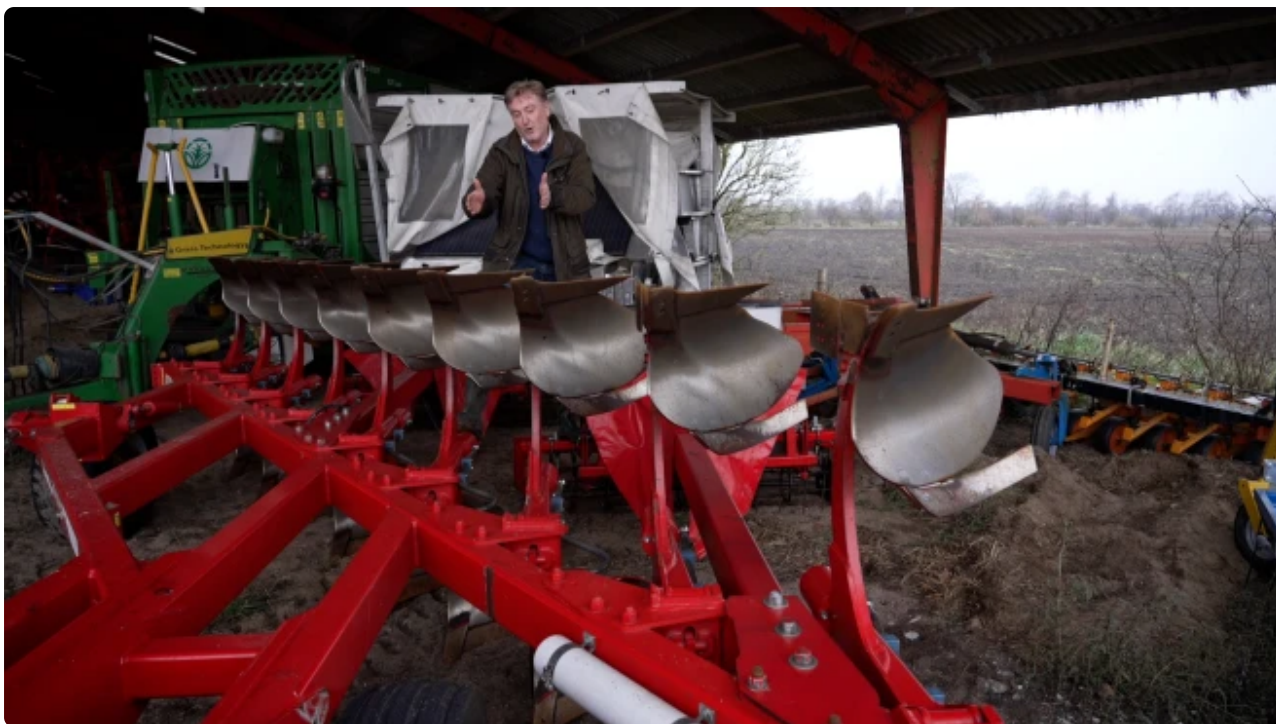
Ploven har monteret en såmaskine, der betyder at afgrøderne kan sås i marken i samme arbejdsgang som pløjningen - lige efter høst. Foto: Uffe Bregendahl
