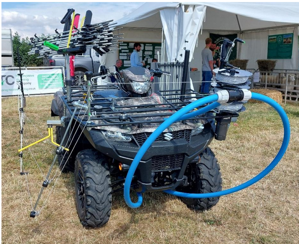
Foto 7: ATV med hegningssudstyr, tromler med hegn (højre side), stativ med hegnspele (venstre side) og bøjle, som holder hegn nede, mens ATV kører over (foto: Ann-Sofie Krogh Andreassen).
