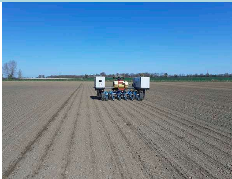
Foto 3. Roesåning udført med Agrobot Robotti.
