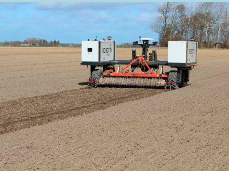
Foto 2. Såbedsharvning udført med Agrobot Robotti og modificeret harve.
