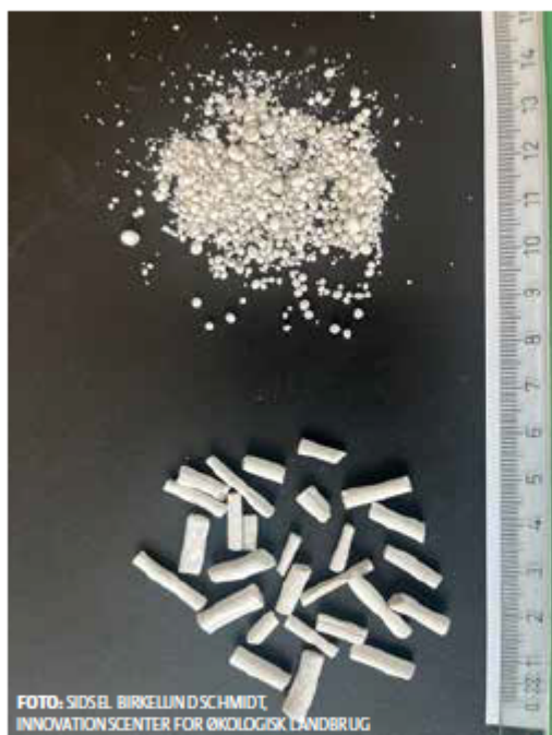
FOTO: SIDSEL BIRKELUND SCHMIDT INNOVATIONSCENTER FOR ØKOLOGISK LANDBRUG Struvit granulat (øverst) og piller (nederst). Pillerne består af fint formaleet struvit (<100 µm Ø) samlet med kartoffelmel og er udviklet i samarbejde med Københavns Universitet.
