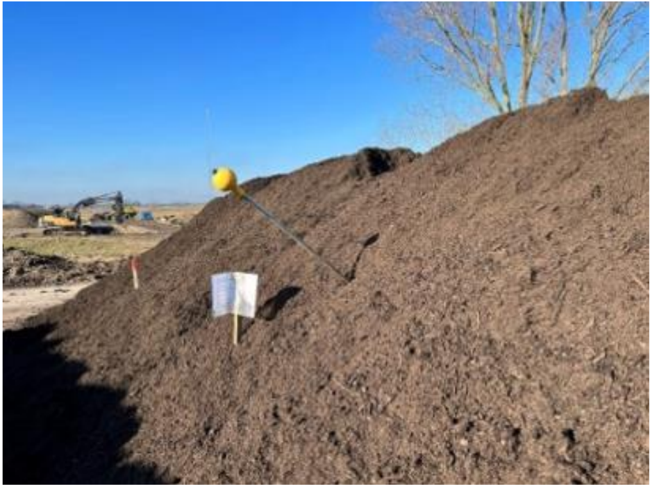
Figur 5-3 Mile, hvor temperaturen er fulgt under hele komposteringsforløbet med et temperaturspyd, der måler både temperaturen i midten og yderst i milen
