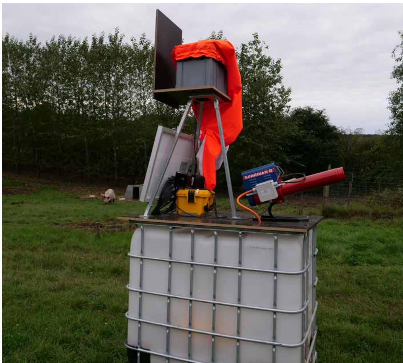
BirdAlert er et intelligent fugledetekterings- og skræmmesystem, som ud over økologisk planteavl også kan bruges på økologiske grisebedrifter til at holde råger og måger væk fra faremarken.
