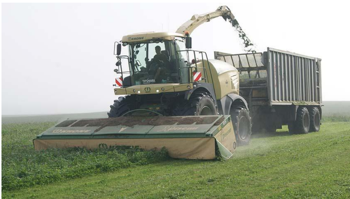
Billede 5: Finsnitner med 6,3 m helsædsbord og frakørselsvogn i SIWI-træk. Foto: Erik Fog, Innovationscenter for Økologisk Landbrug.
