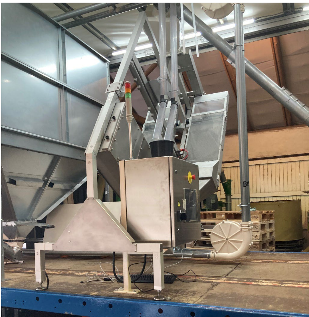
Foto 1. NIR-T proteinsorteringsudstyr monteret på lastbil. Fotograf: Lars Egelund Olsen, Innovationscenter for Økologisk Landbrug
