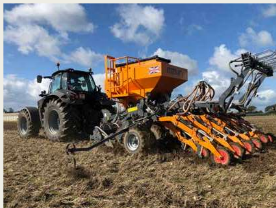
3. Kombisåmaskinen, der ofte bruges til plojefri dyrkning.
