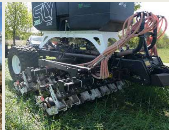
4. En skiveskærssåmaskine er typen, der ofte anvendes i conservation agriculture.
