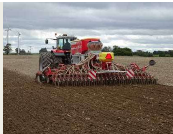
1. Direkte såning med en tandskærssåmaskine.
