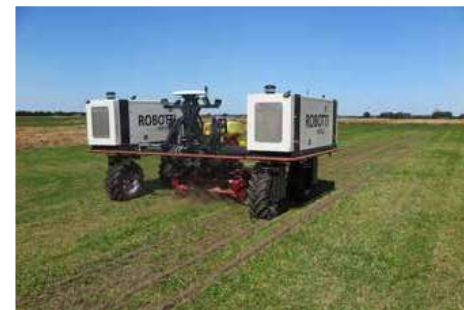
Ved hjælp af en multimaskine udviklet af AgrolIntelli, der både skal kunne fræse, så og slå, kan mikrokloveren holdes kortklippet gennem sæsonen, så opformering af frøukrudt og konkurrence med afgrøden undgås.
