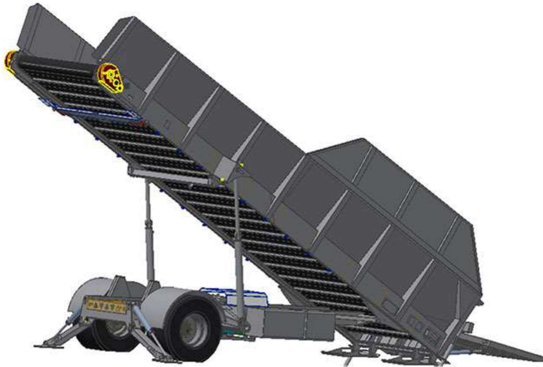
Billede 5. Konstruktionstegning af omlæsser der indgår i Græs-prof. Illustration: SMEMEK.
