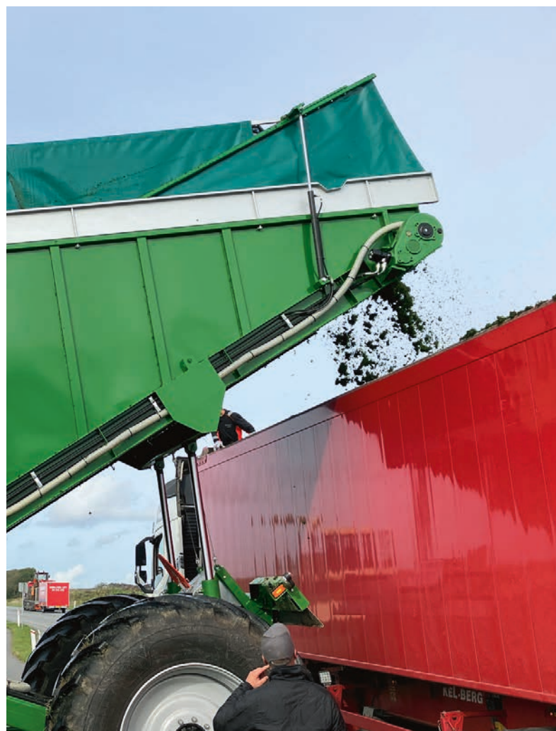
ACJ Greenloader med saftbakke, der drænes til tanken nederst. Saften pumpes til tiptrailereren ved aflæsning. Foto: Henning Sjørsløv Lyngvig, Seges Innovation.
