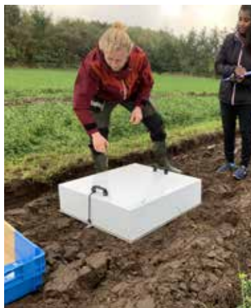
Lattergas måles i samarbejde med Teknologisk Institut i parcel med pløjet jord vha. et såkaldt klimakammer.
