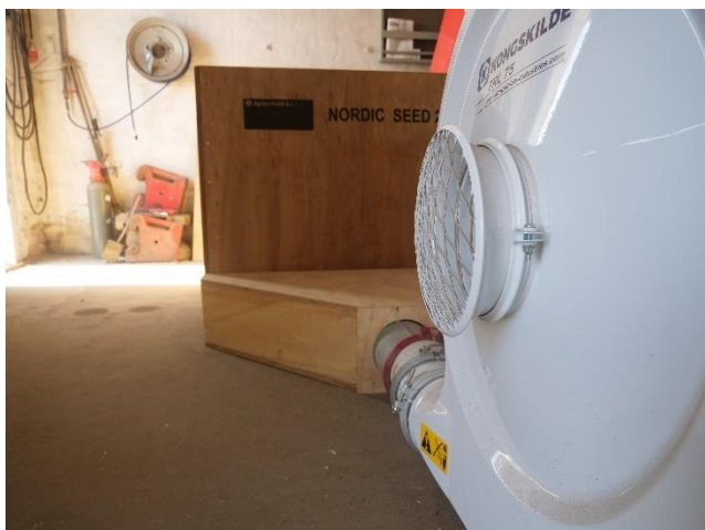
Billede 3. Små tørrekasser sat i en række med fælles blæser. Fotos: Henning Sjørsløv Lyngvig, SEGES
