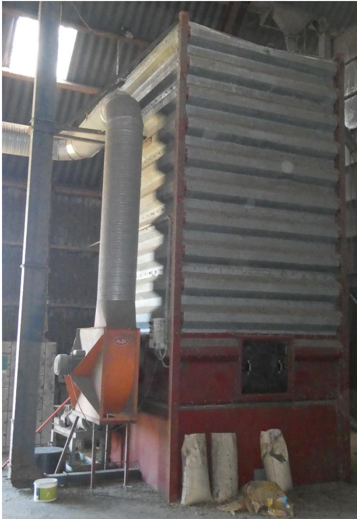
Billede 13. Portionstørreriets kontinuerlige cirkulation under tørringsprocessen sikrer ensartet tørring. Tørreluft blæses udendørs. Fotos: Henning Sjørsløv Lyngvig, SEGES
