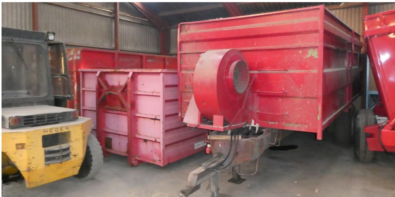
Billede 7. Brugt vogn hvor der er indbygget en perforeret bund og en blæser. Foto: Henning Sjørsløv Lyngvig, SEGES
