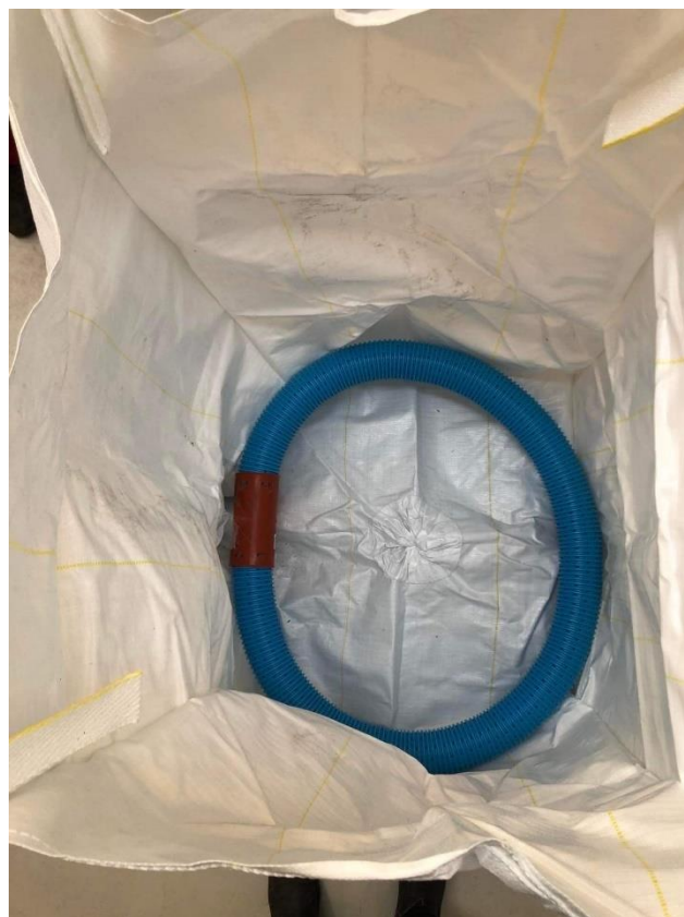
Billede 2. Drønrør anbefales med en diameter på \geq 200 mm.
